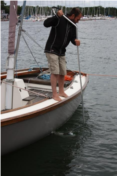
Kuva 2 Powerbrushin toimintaperiaate (kuva Seaboost).
